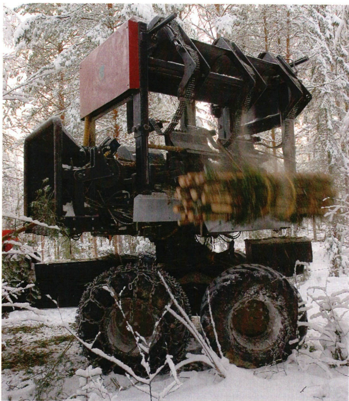
↑ Tiivistetty ja sidottu kokopuupaali pudotetaan paalaimen puristuskammioista maahan ajouran varteen. Seuraava paali on jo osin tehty paalaimen välivarastotilaan.
