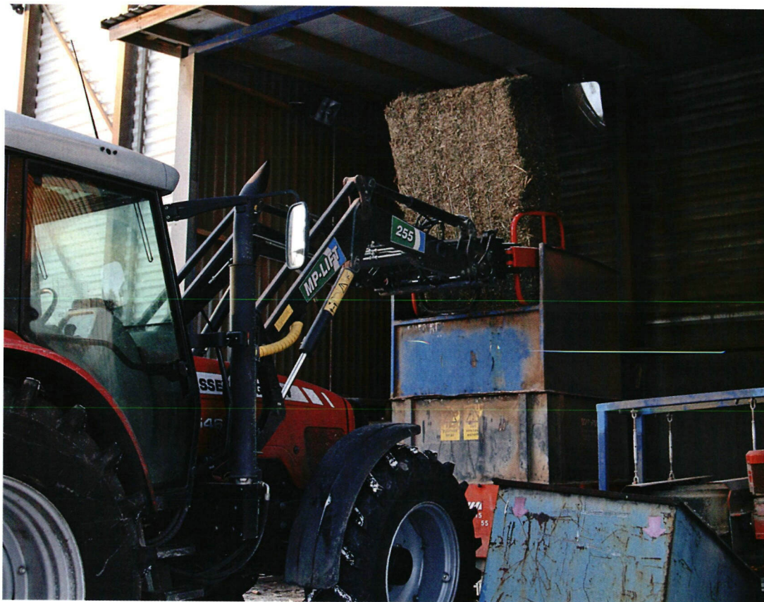
↑ Tästä se lähtee. Rypsipaali solahtaa Weima WL 15 -murskaimen kitaan...
