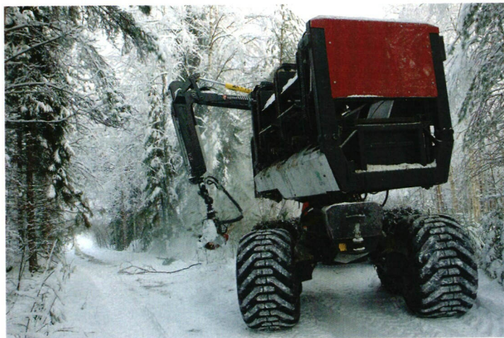
↑ Pasi Romo on kehittänyt ja rakentanut kokopuupaalaimen, joka on asennettu Valmet 801 Combi -korjuurin kuormatilaan. Painoa paalainyksiköllä on runsaat viisi tonnia. Valokuvat: Biotukki Oy
