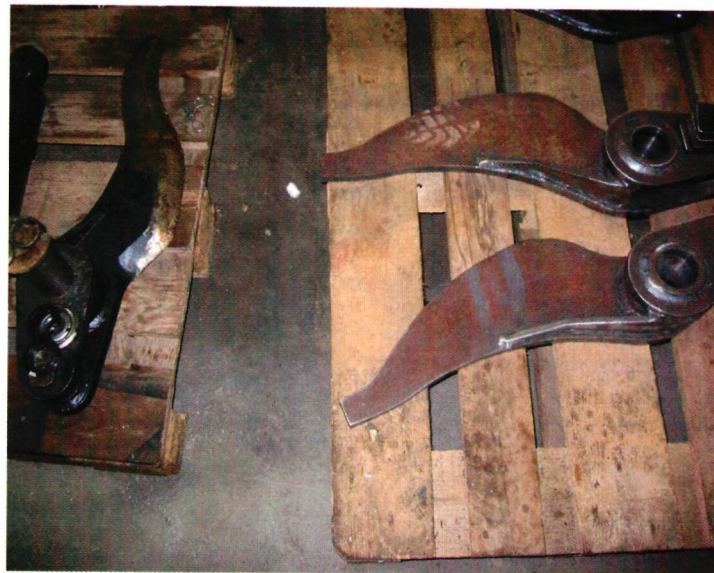
↑ Vasemmalla on ensimmäinen terä, joka otettiin käyttöön keväällä. Oikealla on kaksi aihiota uuden viiden terän sarjasta.
