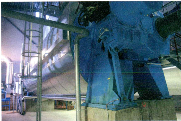
Kuivausrumpuja on kaksi rinnakkain. Niiden yhteisteho on 60 kuutiota tunnissa. Purun alkukosteus on noin 50 prosenttia ja loppukosteus 12. Höyrystynyttä vettä poistuu piipun kautta noin kahdeksan tonnia.
