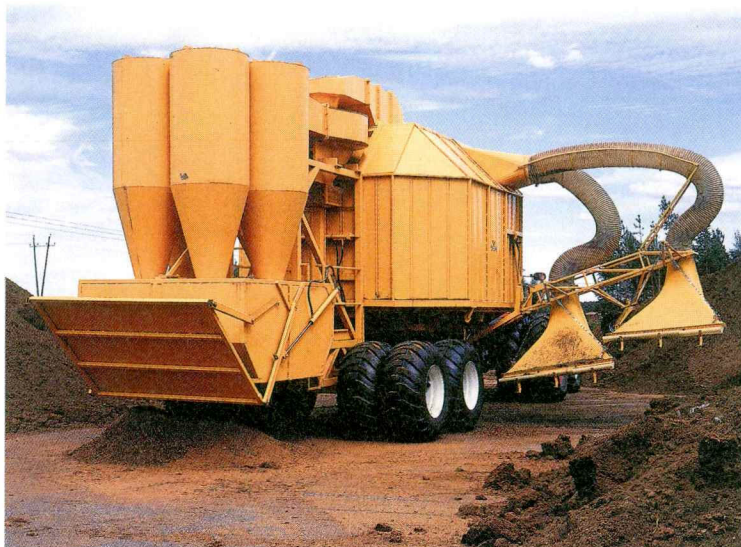
Suokoneet ovat todella suuria ja tehokkaita laitteita. Tällä koneella hoidetaan jyrsinturpeen siirto- tai kuormaustyöt.
