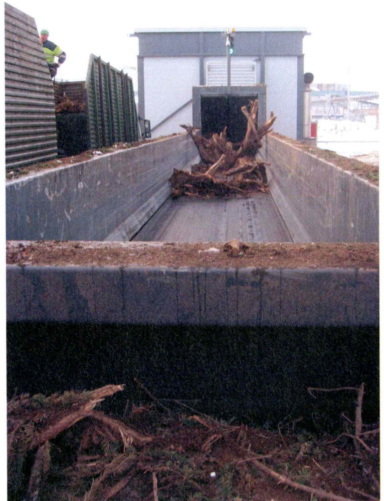
Saalastin uusi murskain on hyvin koteloitu ja sen käyttö on täysin automatisoitu. Metalliesineet pysäyttävät sen heti.
