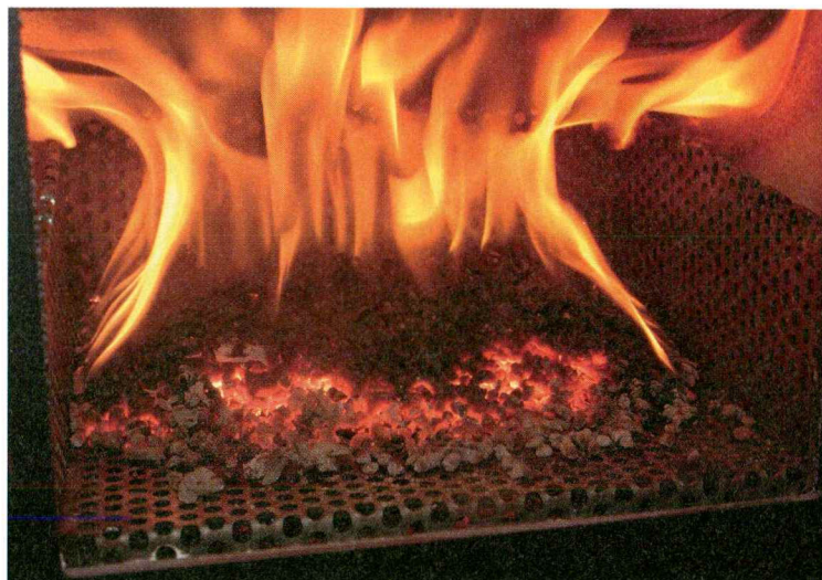
Pelletti-arina toimii hyvin tiivisluukuisessa peltitakassa, jossa vetoa voi säädellä tehokkaasti.
