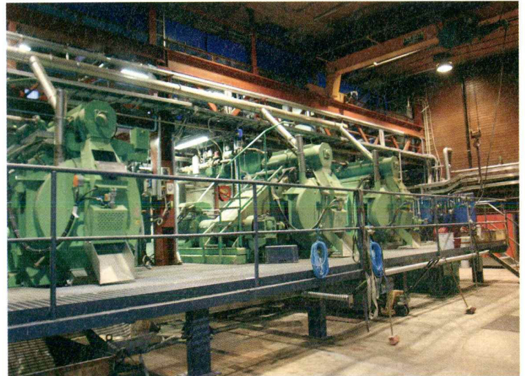
Pellettitehtaan kapasiteettia lisättiin yhdellä puristinlinjalla.
