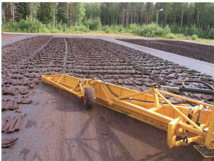
Uudella menetelmällä tuotettua turvetta kootaan asfalttikentältä Aitonevan koealueella.
