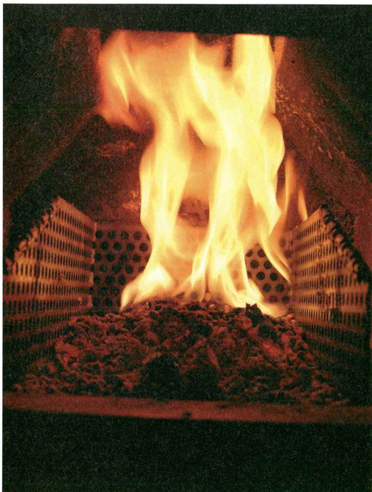
Pelletit palavat hyvin myös saunan uunissa, mutta ilma pitää ohjata tiiviisti polttoarinan alle tilkittämällä myös uunin suuluukku. Kuvassa Pelletti-arinan kiukaaseen sopiva poltinversio.
