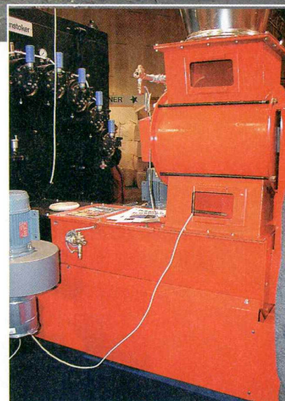
Suurpaalit nostetaan Hverringen tilalla kurottajalla ketjukuljettimelle ja paa-linarut otetaan pois. Lämmitysautomaatiikka hoitaa loput. Olkisilppu puhalletaan kattilahuoneeseen lietsolla.
