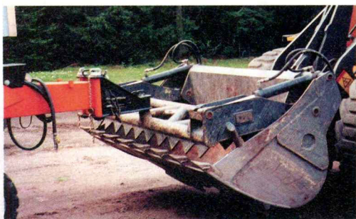
AK 230:n siirtely oli nopeaa monitoimikauhan vetotapilla. Kokeilussa laitteessa oli myös kauko-ohjauksella toimiva hydrauliajo.
