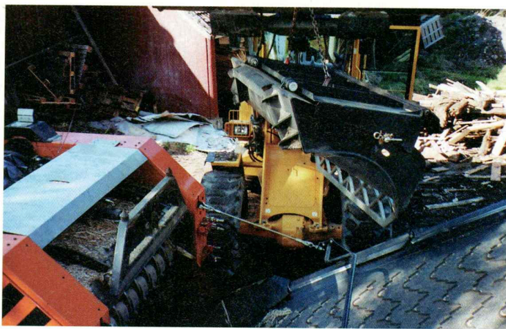
Valmistu mursketta kertakäyttölavoista. Oikealla 280- ja vasemmalla 80-milliselä seulalla tehtyä mursketta. Tikkaisuus väheni selvästi pienemmällä seulalla, mutta molemmat murskeet ovat käypää polttoainetta isohkoille lämpölaitoksille.
