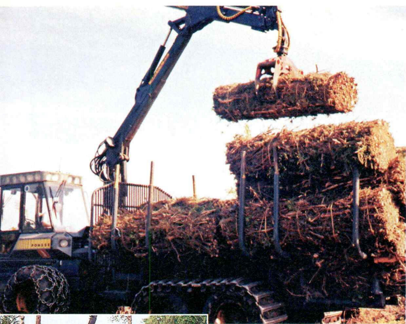
Ponsse Buffaloon on asennettu yksi lisäkarikkapari. Kuormatilaan mahtuu näin kaksi paaliriviä.
