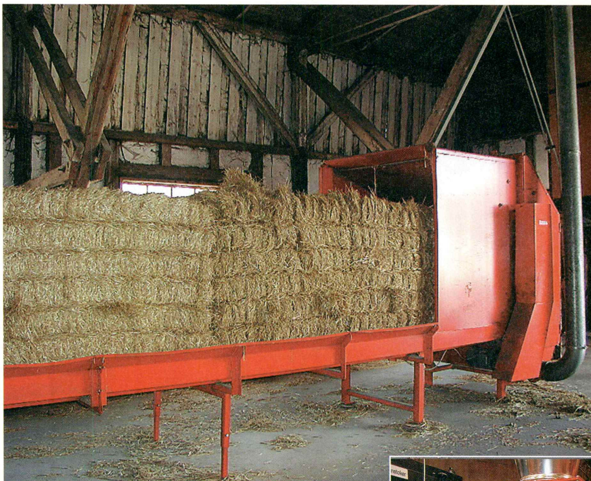
Suurpaalit nostetaan Hverringen tilalla kurottajalla ketjukuljettimelle ja paa-linarut otetaan pois. Lämmitysautomaatiikka hoitaa loput. Olkisilppu puhalletaan kattilahuoneeseen lietsolla.
