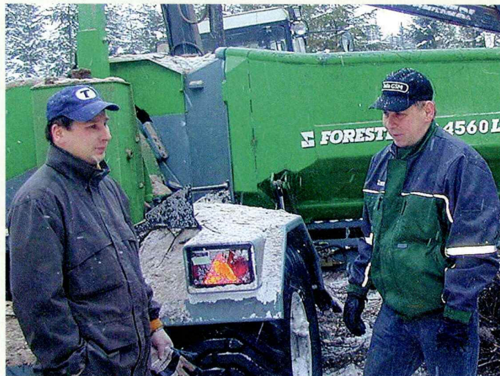
Lämpöyrittäjät Mika ja Arto Utraien ovat investoineet tehokkaaseen rumppahakkuriin, jonka keskimääräiseksi tuntituotannoksi Utraiset arvioivat noin 60 - 80 i-m 3 /h.
