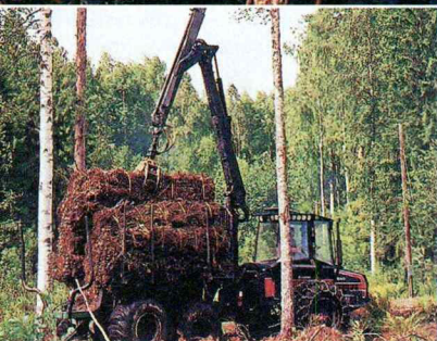
Vakiorakenteisen metsätraktorin kuormatilaan mahtuu yksi paalirivi, runsas kymmenen paalia.
