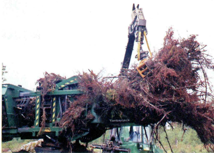
Timberjack 1490D -hakkuutähtepaalain paalaamassa kuivahtanutta hakkuutähdettä päätehakkuukuusikossa. Paalaimen syöttö helpottuu, jos syöttöpöytä pidennetään ja levennetään.
