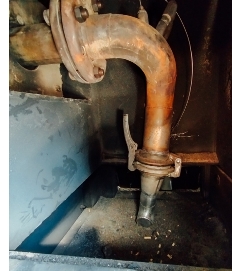
Pyrolyysireaktori kuvattuna tulipesän sisältä.
