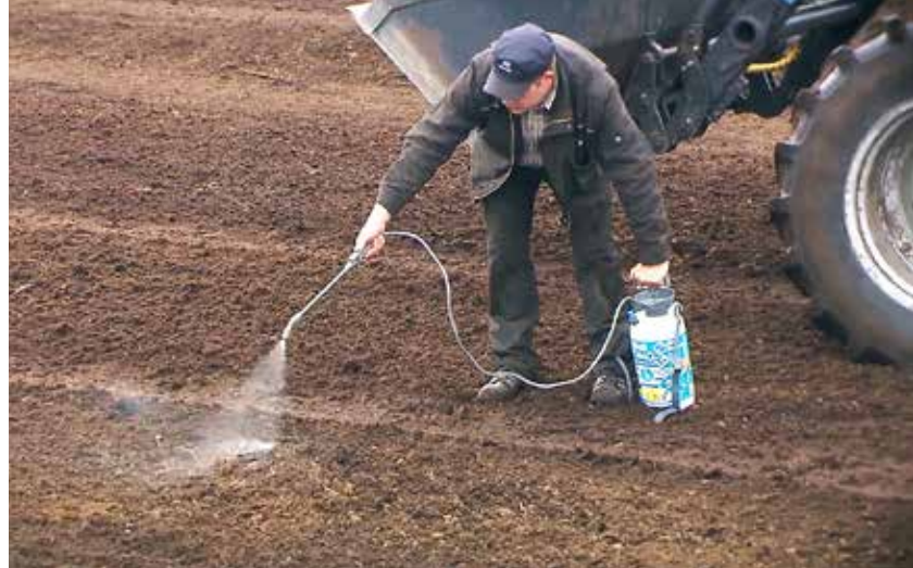
↑ Turvekenttäpaloissa oleellista on alkusammutus, jota varten turvetuotannon vetokoneina käytettävissä traktoreissa on 200 litran vesisäiliö, paineistettava käsiruisku, ämpäri ja lapio.
