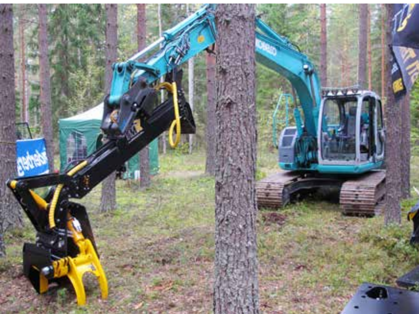
↑ Pellonreunojen ja muiden vastaavanlaisten kohteiden hakkuissa toimivat monet kaivuriin sovitettavat energiakourat, esimerkiksi TMK. Hinta on selvästi halvempi kuin muut energiapuun kaatopäät, joissa on karsintaominaisuuksia.
