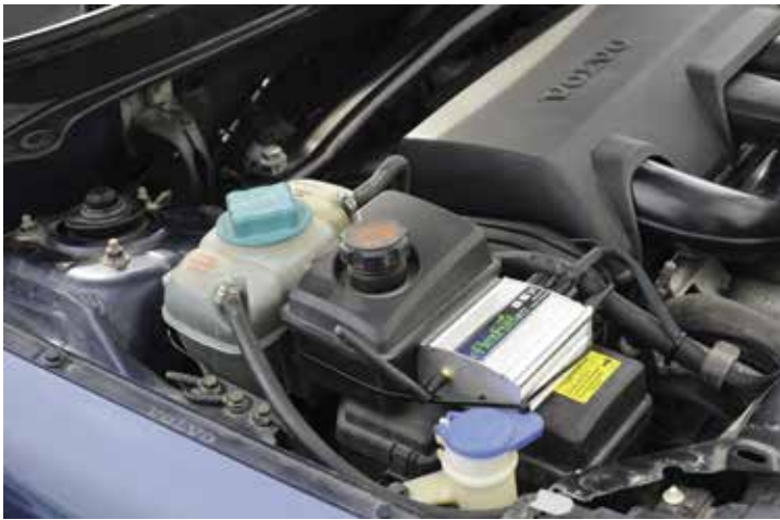
↑ Bensiinikäyttöisiä autoja voidaan muuttaa käyttämään E85-korkeaseosetanolia varsin yksinkertaisella muutoksella. Kuva: StepOne Tech Oy
