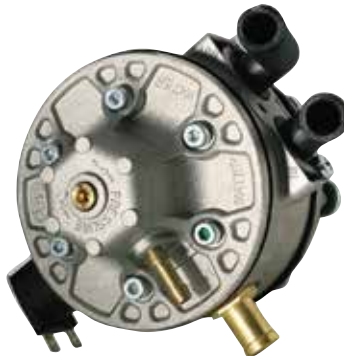
↑ Kaasusäiliössä kaasu on noin 250 baarin paineessa. Sieltä se johdetaan auton pohjaa pitkin moottoriin. Magneettiventtiili aukaisee kaasunsyötön moottoritilaan asennettavaan paineenalennusventtiiliin, joka pudottaa paineen moottorille sopivaksi, noin yhden baarin paineeseen. Kuva: Versus Autogas
