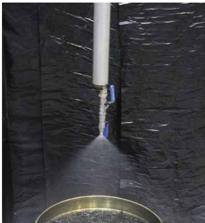
↑ Mustien pellettien säänkestävyys on parempi kuin tavallisten puupellettien, mikä helpottaa logistiikkaa. Kuva VTT:n sadetuskokeesta.
