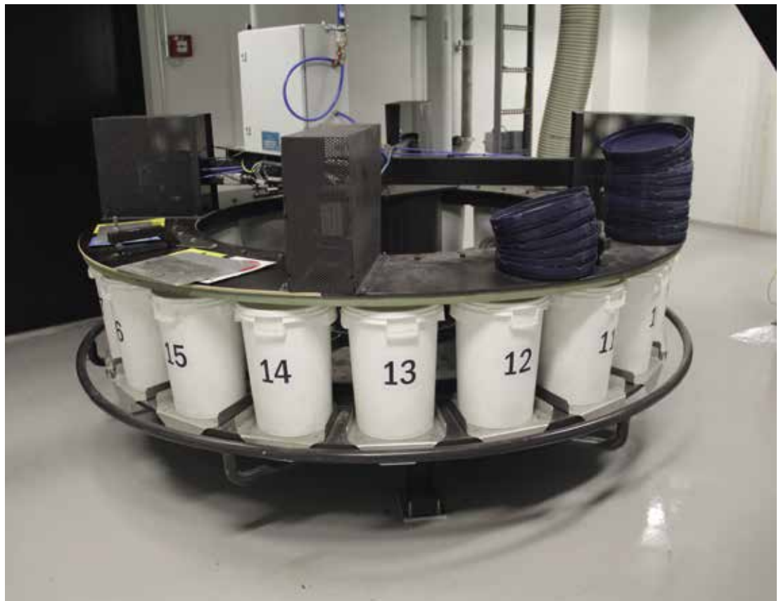
↑ Automaattinen näytteenottojärjestelmä kerää polttoainenäytteet turvallisesti.
