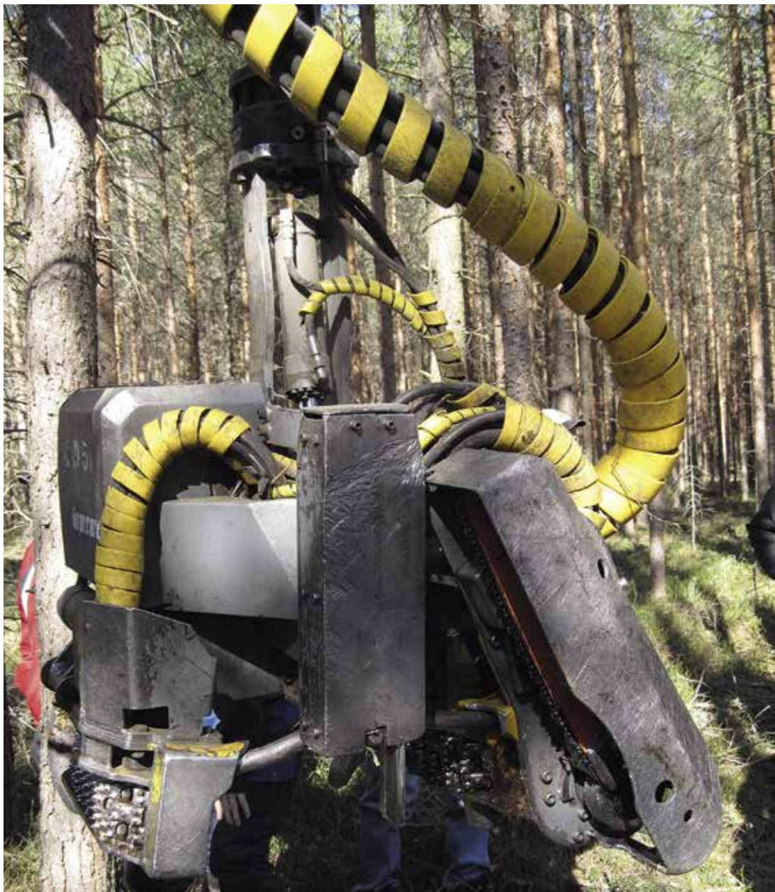
◀ Hydraulisesti toimiva halkaisuterä on liitetty muutoin tavanomaiseen hakkuupäähän. Kuva: Tuomas Hakonen.
