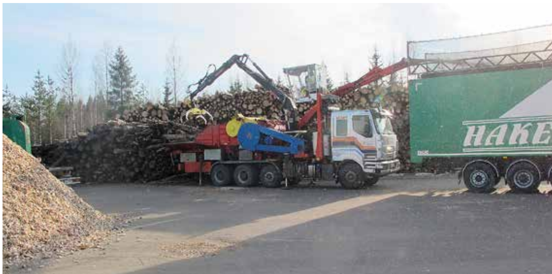
↑ Hakkuriauton siirtäminen pois kasan läheltä yöksi on nykyään normaalitoimenpide, joka vaikkapa sähkövian sattuessa pelastaa suurelta palokuormalta.
