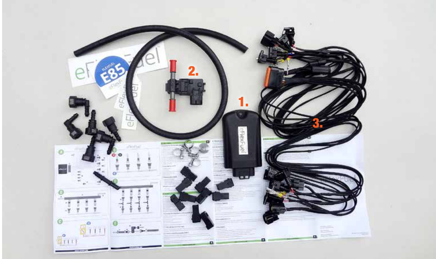
↑ eFlexFuel-etanolimuutossarja koostuu varsin sirokokoisesta keskusyksiköstä (1), etanolianturista (2) sekä lämpötila-anturin sisältävästä jotosarjasta (3) ja muista asennukseen tarvittavista liittimistä ja tarvikkeista.
