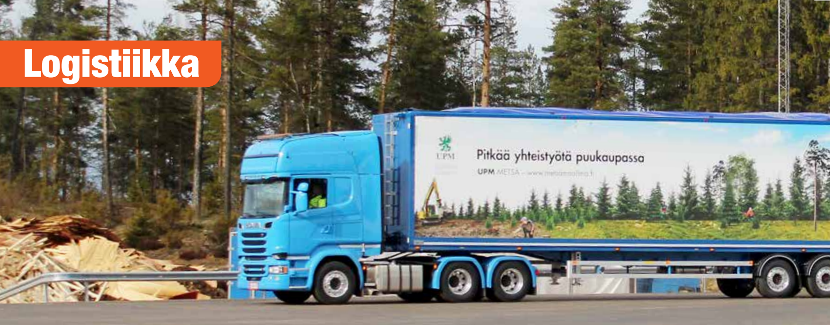
↑ Kuljetusliike Wickström oy:n 85-tonninen ja 34-metrinen hakeyhdistelmä. Kuva Pirjo Venäläinen
