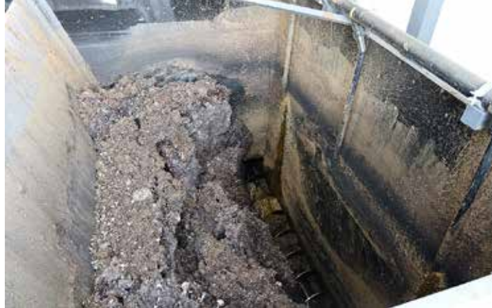
↑ Prosessiin tuleva lanta kipataan vastaanottokonttiin, josta massa siirtyy ruuvilla eteenpäin. Kontissa on hydraulisesti puskettaava seinä.
