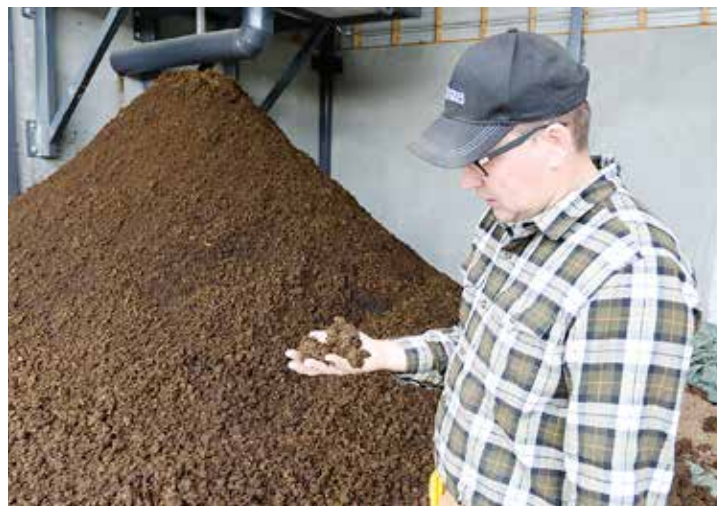
↑ Mädätyksen jälkeen massa separoidaan ja kuiva- ja nestejakeet ovat valmiita levitettäväksi pellolle.
