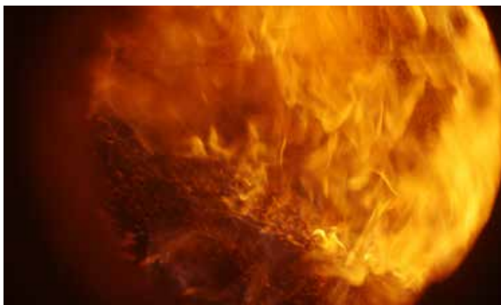
↑ Paksu hiilloskerros toimii samalla niin kutsuttuna aktiivihiihtäjäsuodattimena, joka olennaisesti vähentää lentotuhkan määrää sekä sitä myötä puhdistamisen tarvetta.
