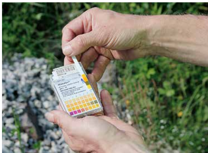
↑ Megaturve Oy:n tuotantoalueet sijaitsevat sulfaattimaiden alueella, joten veden laatua seurataan tarkasti. Kuvaushetkellä Jahtavisnevalta laskevan veden ph oli noin 6.
