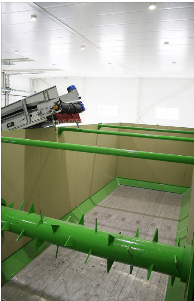
↑ Kuivat syötteet sekoitetaan syötteenvalmistussäiliössä, missä on kävelevä pohja ja repijä.
