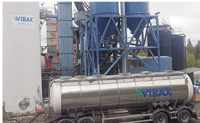
Kuvassa Wibaxin toimittama bioöljytankki ja muut bio- ja lämmön tuotantoon tarvittavat laitteet Skanska Östersundin asfalttiasemalla.
