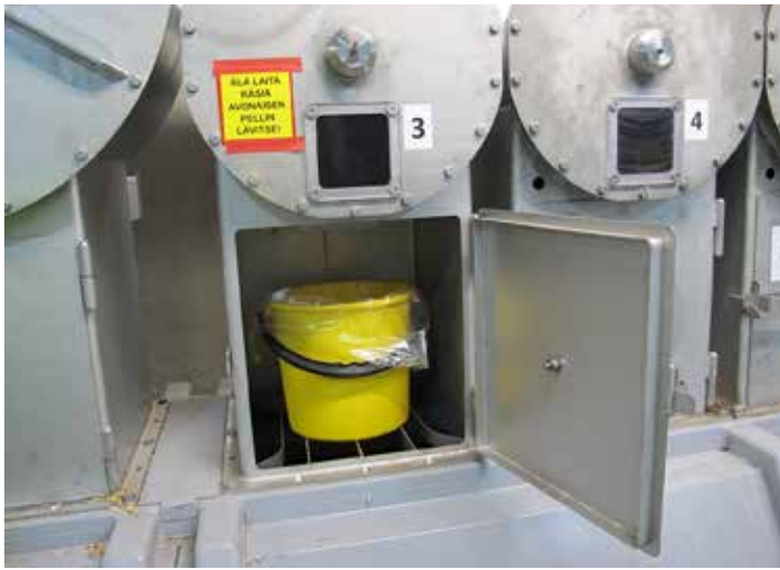
↑ Yhden toimittajan yhden päivän aikana kerätyt näytteet samasta polttoainelaadusta sekoitetaan myllyssä, ja siitä saadaan edustava vuorokausinäyte, joka putoaa ämpäriin ja viedään laboratorioon.
