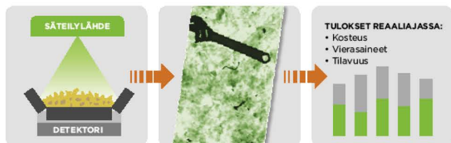
↑ Kaikki kuljettimella menevä materiaali mitataan röntgenillä.
