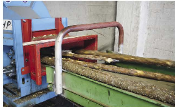
↑ Koko prosessin ohjaus ja automaatio on rakennettu yhdeltä kannettavalta ohjattavaksi. Haketuksen syöttö tapahtuu vielä käsipellillä.
