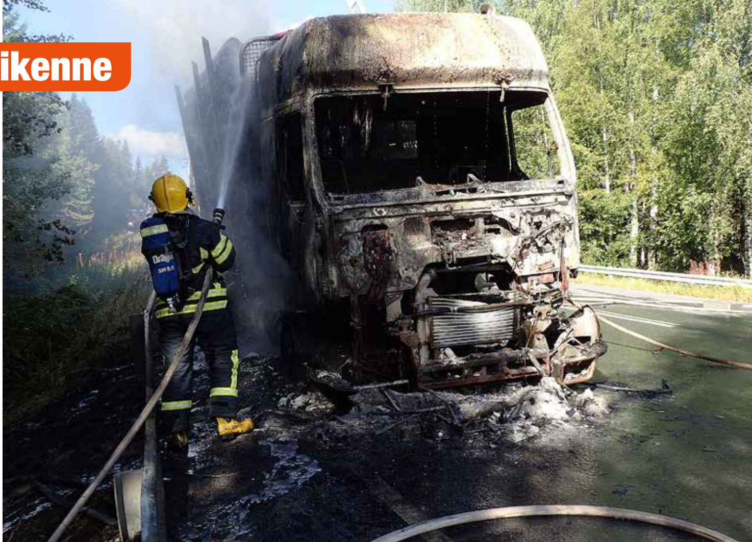
↑ Kuorma-auton tai kuorma-auton perävaunun syttymisen taustalla on usein turpeen, hakkeen tai purun päätyminen lastitilan ulkopuolelle ajoneuvon laitteisiin tai rakenteisiin, yleisimmin moottoritilaan, pakoputkiston läheisyyteen tai akustoon.
