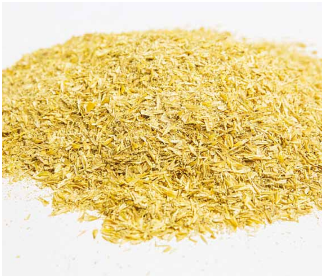
↑ Koskenkorvan tehtaalle rakennettu biovoimalaitos käyttää polttoaineenaan ohran kuorta ympärivuotisesti.
