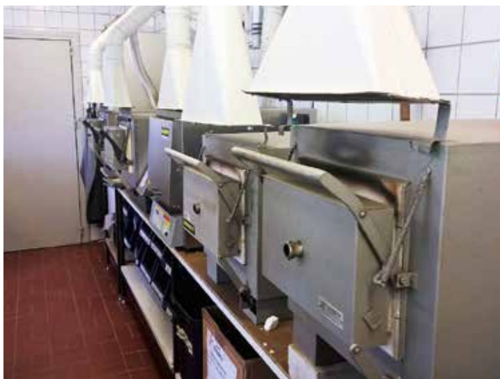
↑ Tuhkauuneissa määritetään analyysinäytteen tuhkapitoisuudet 550 tai 815 celsius-asteen lämpötilassa.
