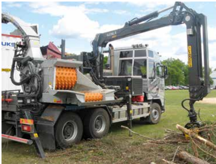
↑ Kuormaimen hallintapaikka vaikuttaa värinään. Rakenteissa, joissa kuormainta hallitaan siihen kiinnitetystä ohjaamosta käsin, värinä on suurempaa kuin muunlaisissa rakenteissa. Auton ohjaamossa kärsitään värinästä ja kuumuudesta selvästi vähemmän.
