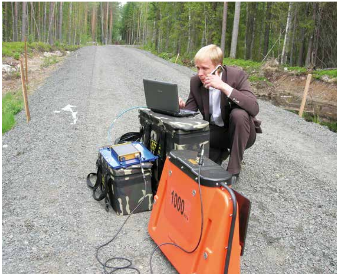
↑ Suomalaisella asiantuntemuksella rakennettu metsätie Petroskoin kaupungin länsipuolella kesäkuussa 2015. Metsätien rakentamisen opettaja Aleksander Petrov Petroskoin yliopiston metsäinstituutista analysoi tien rakennetta maatutkalla. Kuva: Anton Sokolov.
