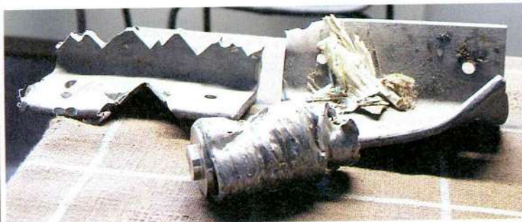
Magneetti ei tunnista esimerkiksi haponkestävää terästä, mikä tietää korjaustarvetta. Pahimassa tapauksessa koko teräsarja joudutaan uusimaan.
